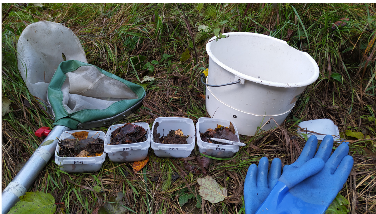
Kuva 29. Koskialueiden pohjaeläinnäytteenotossa käytetään ns. potkuhaavia näytteiden keräämiseen tarkoin suunnitelluilta pohjahabitaateilta. Kuvassa haavi, seulasanko ja neljä näytettä, joihin vielä lisätään lopuksi etanolia säilöntäaineeksi.
