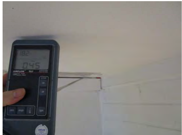
Kuvat 162-165: Vuotoilmavirtauksia ulkoseinän ja yläpohjan liitoksesta (60)
