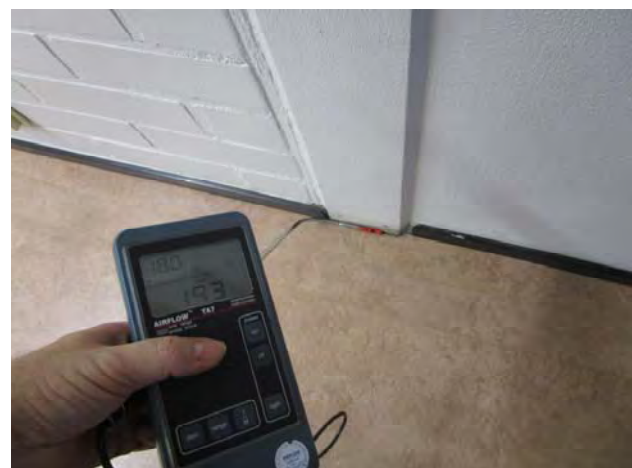
Kuvat 202 ja 203: Vuotoilmavirtauksia ulkoseinien sisänurkan ja välipohjan liitoksessa olevasta halkeamasta (74)
