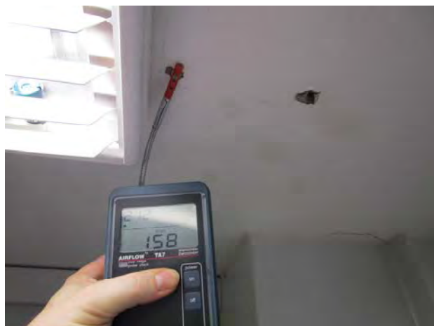
Kuvat 173 ja 174: Vuotoilmavirtauksia katossa olevista vanhoista kiinnityspisteistä (64)
