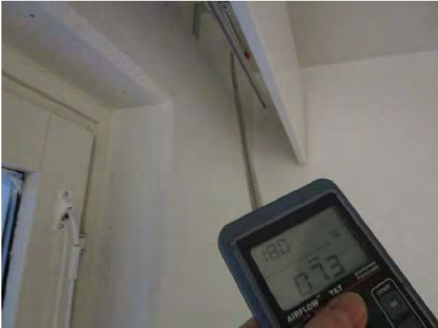
Kuvat 208-211: Vuotoilmavirtauksia ulkoseinien ulkonurkan ja yläpohjan liitoksista (76)
