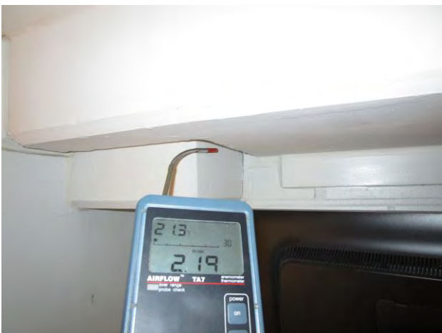
Kuvat 52-55: Vuotoilmavirtauksia rakenneliittymissä ja rakenteissa olevista halkeamista (19)
