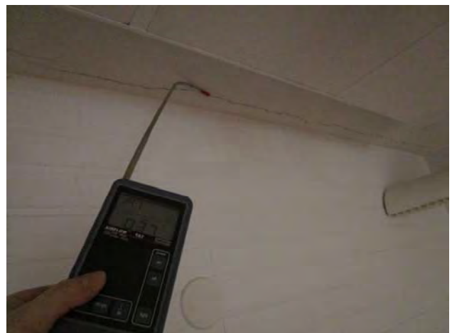
Kuvat 76-79: Vuotoilmavirtauksia väliseinän ja välipohjan liitoksessa olevasta halkeamasta (26)
