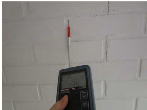
Kuvat 193-196: Vuotoilmavirtauksia tiiliseinässä olevista halkeamista (71)
