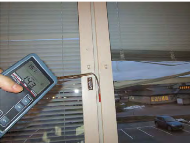
Kuvat 66-69: Vuotoilmavirtauksia ikkunan karmin ja puitteen välistä (23)
