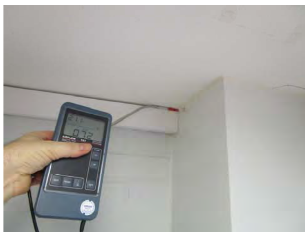
Kuvat 175 ja 176: Vuotoilmavirtauksia väliseinän ja yläpohjan liitoksesta (65)
