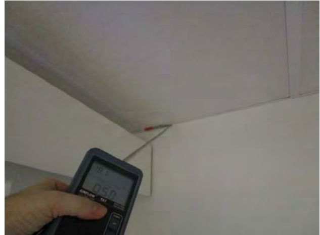
Kuvat 208-211: Vuotoilmavirtauksia ulkoseinien ulkonurkan ja yläpohjan liitoksista (76)
