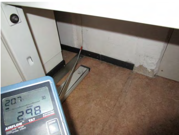
Kuvat 20-23: Vuotoilmavirtauksia betonipilarin ja seinärakenteen liitoksesta välipohjaan (7)
