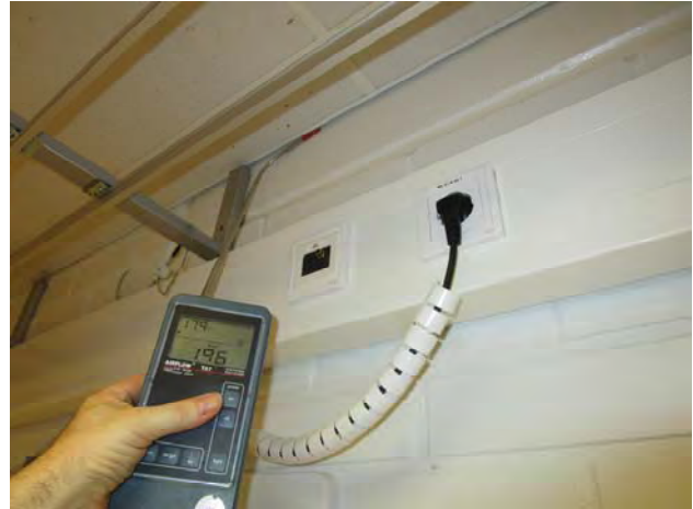
Kuvat 121-124: Vuotoilmavirtauksia väliseinän ja yläpohjan liitoksesta (45)
