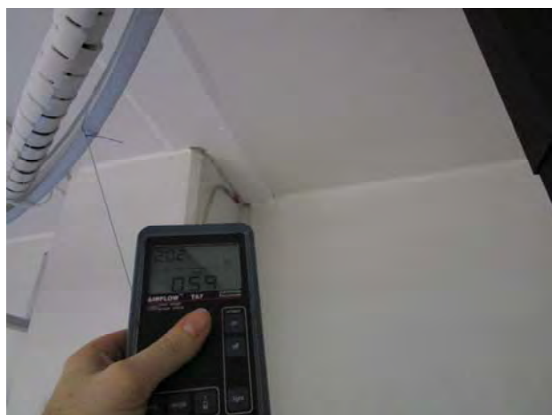
Kuvat 181-184: Vuotoilmavirtauksia yläpohjassa olevasta liikuntasaumasta (67)
