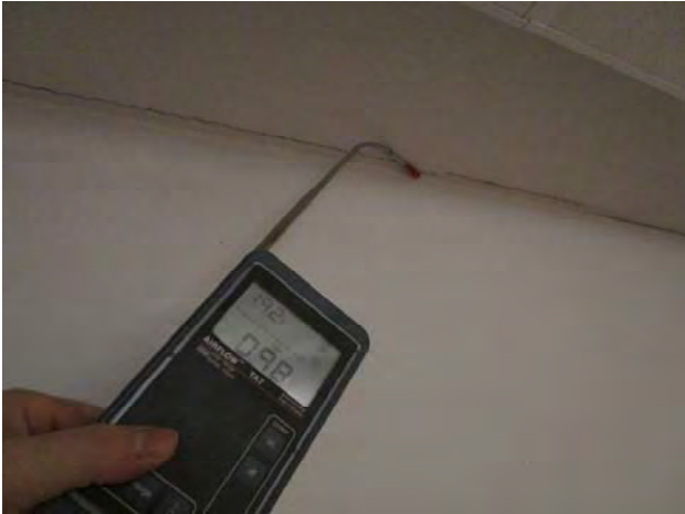
Kuvat 72-75: Vuotoilmavirtauksia ulkoseinän ja välipohjan liitoksessa olevasta halkeamasta (25)
