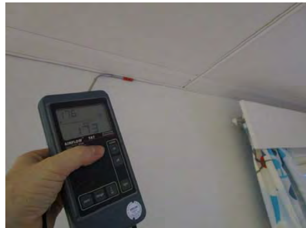
Kuvat 204-207: Vuotoilmavirtauksia ulkoseinän ja yläpohjan liitoksesta (75)
