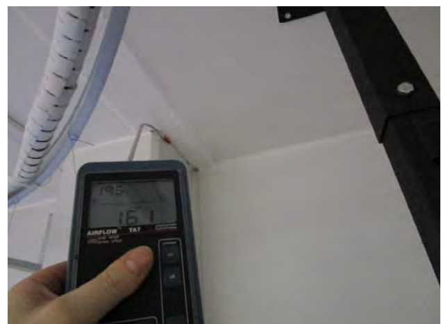
Kuvat 181-184: Vuotoilmavirtauksia yläpohjassa olevasta liikuntasaumasta (67)
