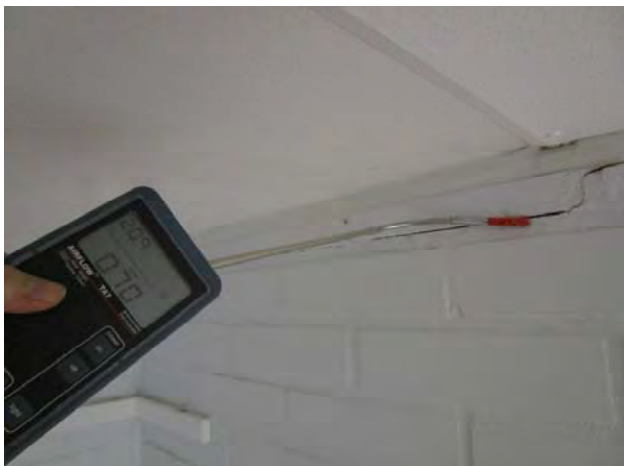
Kuvat 193-196: Vuotoilmavirtauksia tiiliseinässä olevista halkeamista (71)
