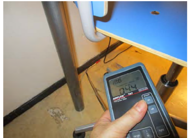
Kuvat 119 ja 120: Vuotoilmavirtauksia ulkoseinän ja välipohjan liitoksesta (44)
