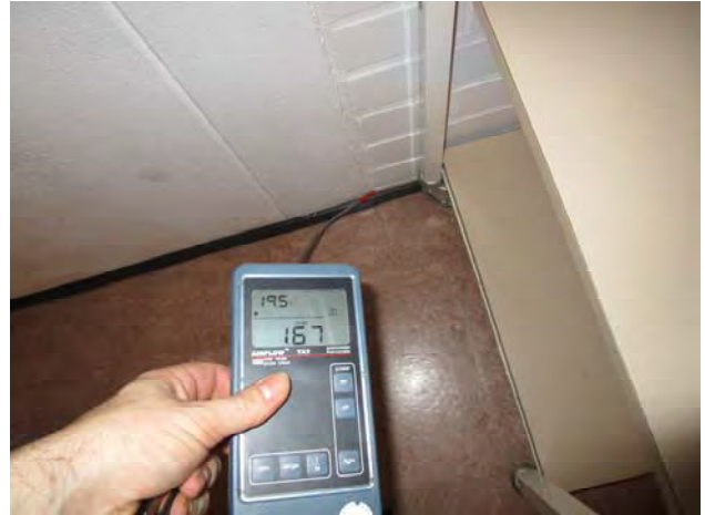
Kuvat 80 ja 81: Vuotoilmavirtauksia ulkoseinien sisänurkan liitoksesta välipohjaan (27)
