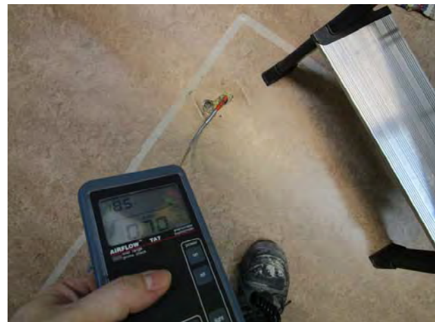
Kuvat 132 ja 133: Vuotoilmavirtauksia lattiarakenteesta käytöstä poistetuista kaapeliputkista (48)
