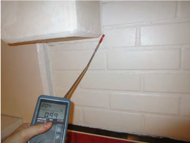
Kuvat 59-62: Vuotoilmavirtauksia rakenneliittymissä olevista halkeamista (21)
