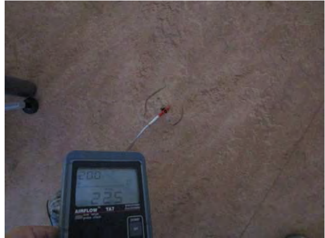
Kuvat 148 ja 149: Vuotoilmavirtauksia välipohjan rakenteesta käytöstä poistetusta läpivientiputkesta (54)
