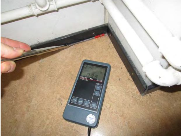
Kuvat 8-11: Vuotoilmavirtauksia betonipilarin ja välipohjan liitoksesta (3)
