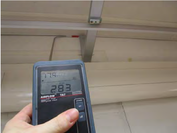
Kuvat 121-124: Vuotoilmavirtauksia väliseinän ja yläpohjan liitoksesta (45)
