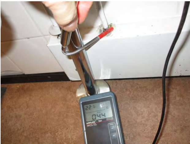
Kuvat 56-58: Vuotoilmavirtauksia vesiputkille tehdystä kotelosta (20)
