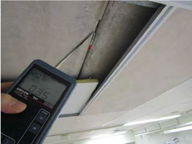
Kuvat 177-180: Vuotoilmavirtauksia ontelolaattojen välisestä saumasta alaslasketun kattoverhouksen yläpuolella. Alaslasketussa kattoverhouslevyssä on kosteusvauriojäljet. (66)
