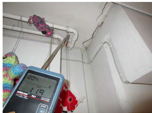
Kuvat 34 ja 35: Vuotoilmavirtauksia välipohjaan tehdystä putkiläpiviennistä (12)
