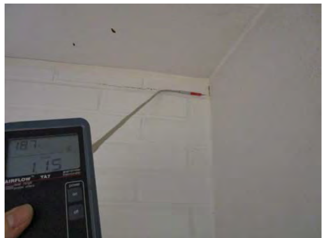
Kuvat 166 ja 167: Vuotoilmavirtauksia väliseinän tiilimuurauksessa olevasta halkeamasta (61)
