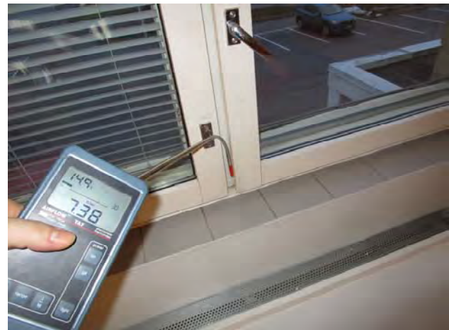
Kuvat 66-69: Vuotoilmavirtauksia ikkunan karmin ja puitteen välistä (23)
