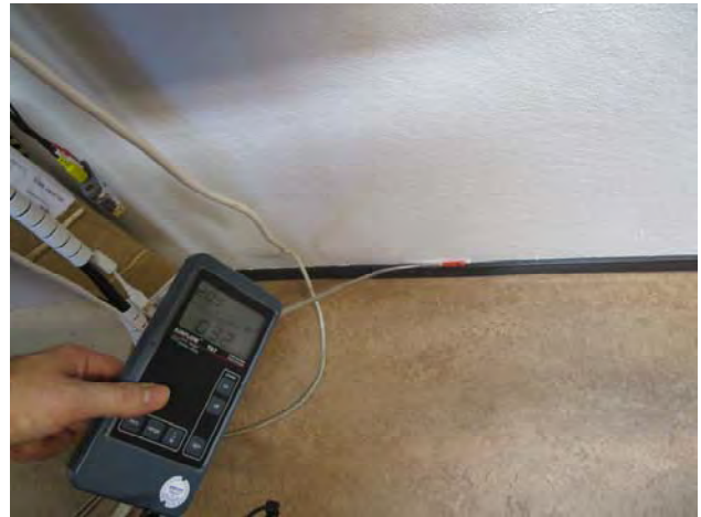
Kuvat 153 ja 154: Vuotoilmavirtauksia ulkoseinän ja välipohjan liitoksesta (56)
