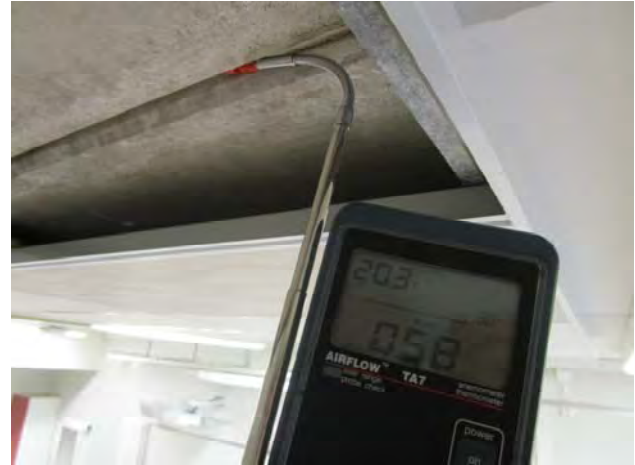
Kuvat 177-180: Vuotoilmavirtauksia ontelolaattojen välisestä saumasta alaslasketun kattoverhouksen yläpuolella. Alaslasketussa kattoverhouslevyssä on kosteusvauriojäljet. (66)
