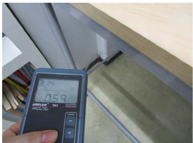
Kuvat 171 ja 172: Vuotoilmavirtauksia betonipilarin ja välipohjan välisestä liitoksesta (63)
