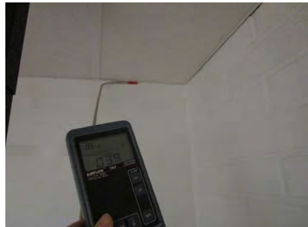
Kuvat 214-217: Vuotoilmavirtauksia ulkoseinän ja yläpohjan liitoksesta (78)
