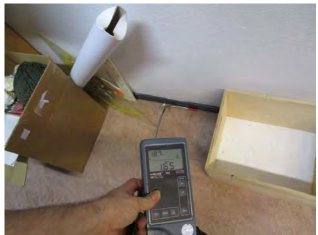
Kuvat 140-143: Vuotoilmavirtauksia ulkoseinien ja välipohjan liitoksesta (51)
