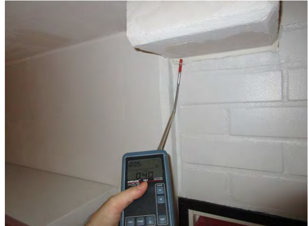
Kuvat 59-62: Vuotoilmavirtauksia rakenneliittymissä olevista halkeamista (21)
