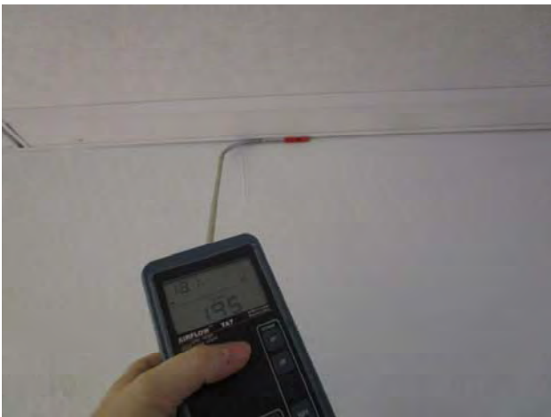
Kuvat 204-207: Vuotoilmavirtauksia ulkoseinän ja yläpohjan liitoksesta (75)
