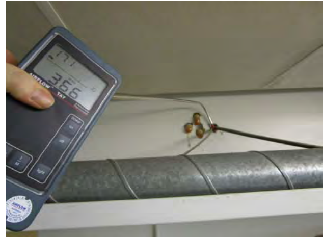
Kuvat 233 ja 234: Vuotoilmavirtauksia ulkoseinässä olevasta kaapeliläpiviennistä (84)
