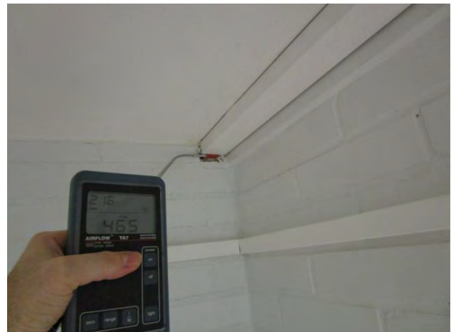
Kuvat 18 ja 19: Vuotoilmavirtauksia väliseinään kaapeleille tehdystä läpiviennistä (6)
