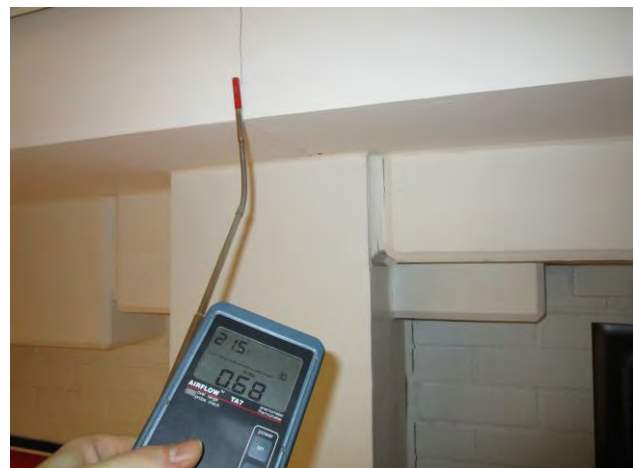
Kuvat 52-55: Vuotoilmavirtauksia rakenneliittymissä ja rakenteissa olevista halkeamista (19)
