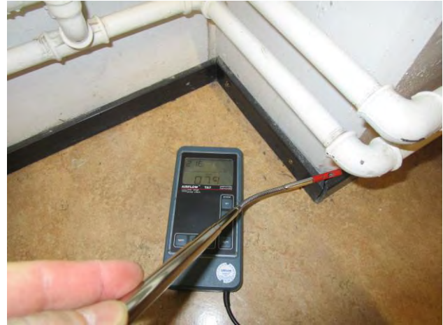
Kuvat 8-11: Vuotoilmavirtauksia betonipilarin ja välipohjan liitoksesta (3)
