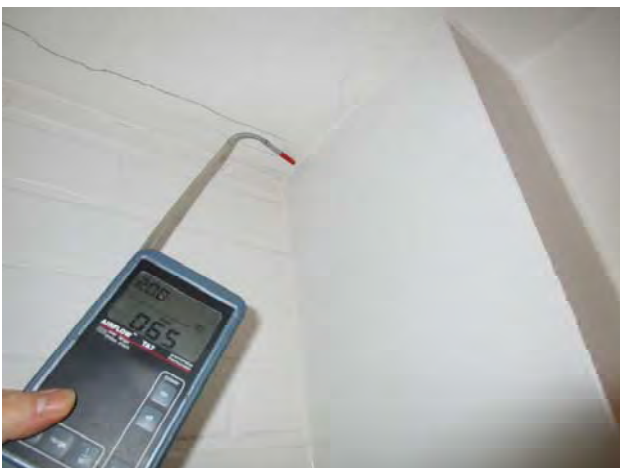
Kuvat 76-79: Vuotoilmavirtauksia väliseinän ja välipohjan liitoksessa olevasta halkeamasta (26)
