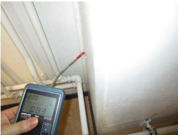
Kuvat 1-4: Vuotoilmavirtauksia betonipilarin ja seinärakenteen välisessä saumauksessa olevista halkeamista (1)
