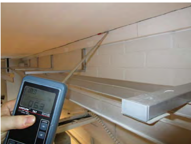
Kuvat 125-128: Vuotoilmavirtauksia väliseinän ja yläpohjan liitoksessa olevasta halkeamasta (46)
