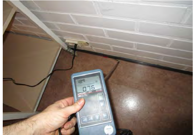
Kuvat 85 ja 86: Vuotoilmavirtauksia väliseinän ja välipohjan liitoksesta (29)
