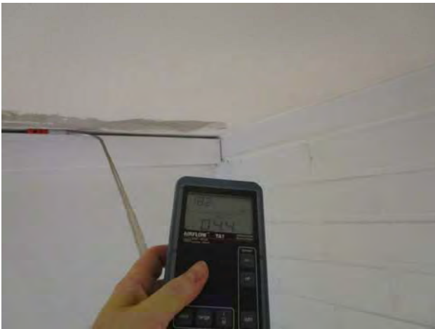
Kuvat 162-165: Vuotoilmavirtauksia ulkoseinän ja yläpohjan liitoksesta (60)
