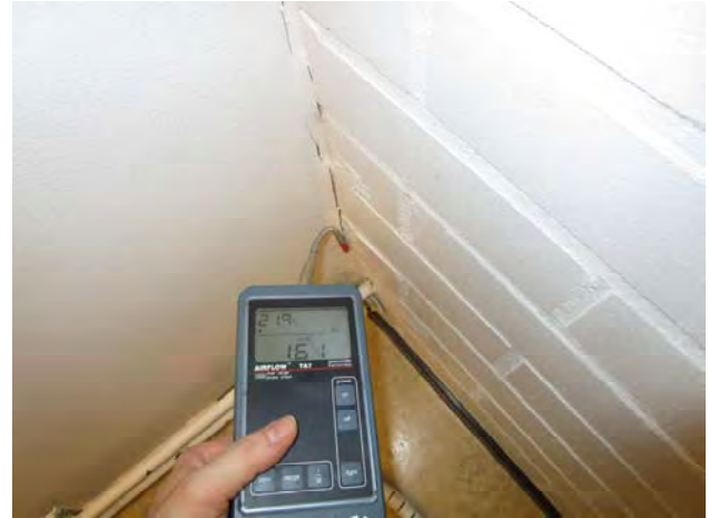
Kuvat 117 ja 118: Vuotoilmavirtauksia väliseinän ja kotelorakenteen liitoksessa olevasta halkeamasta (43)
