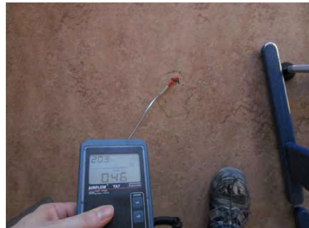
Kuvat 146 ja 147: Vuotoilmavirtauksia välipohjan rakenteesta käytöstä poistetusta läpivientiputkesta (53)
