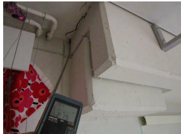
Kuvat 30-33: Vuotoilmavirtauksia betonirakenteiden liitoksissa olevista halkeamista (11)
