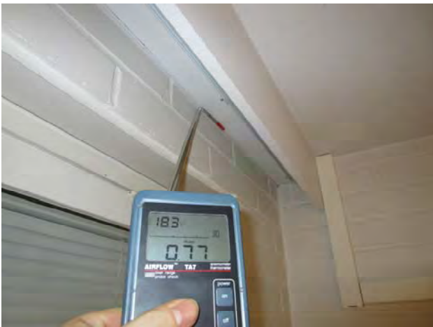
Kuvat 223-226: Vuotoilmavirtauksia yläpohjaverhouksen takaa kattoverhouksen ja ulkoseinän liitoksessa olevasta raosta (85)
