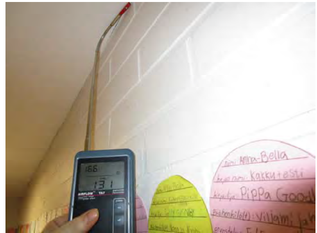
Kuvat 233-236: Vuotoilmavirtauksia väliseinän ja yläpohjaverhouksen liitoksesta (89)
