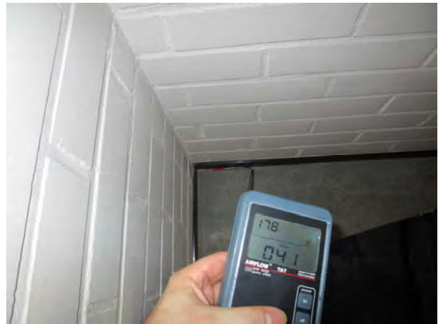
Kuvat 219 ja 220: Pieniä vuotoilmavirtauksia ulkoseinän ja alapohjan liitoksesta (83)
