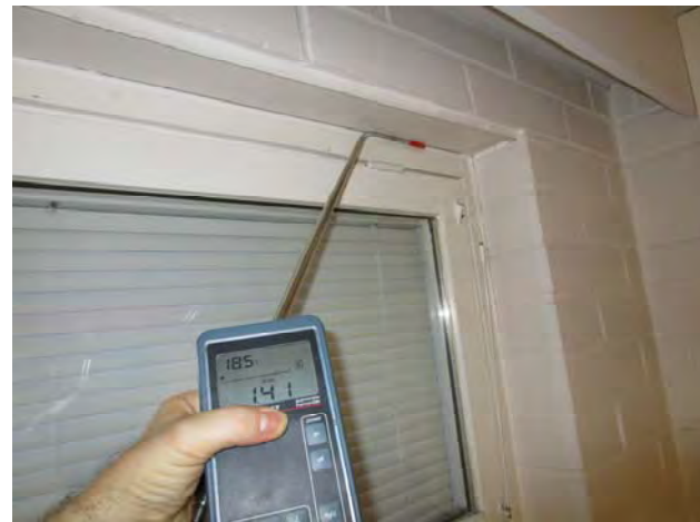
Kuvat 213-216: Vuotoilmavirtauksia ikkunan karmin ja seinärakenteen liitoksesta (81)
