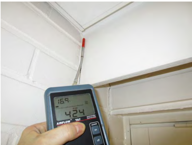
Kuvat 51-54: Vuotoilmavirtauksia ulkoseinän ja yläpohjan liitoksesta verholautarakenteen takaa (21)
