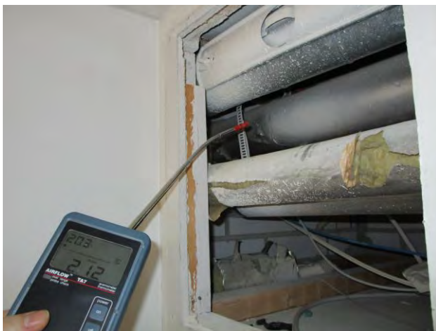
Kuvat 39-42: Vuotoilmavirtauksia lämmönjakohuoneen vastaiseen seinään tekniikalle tehdyistä ja puutteellisesti tiivistetyistä läpiviennistä (17)
