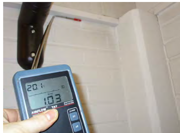
Kuvat 256-259: Vuotoilmavirtauksia tiiliseinien liitoksesta korkean tilan seinärakenteeseen (98)
