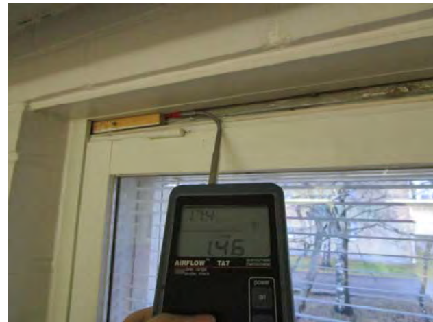
Kuvat 167-170: Vuotoilmavirtauksia ikkunan karmirakenteen ja ulkoseinän sisäkuoren välisestä raosta (62)
