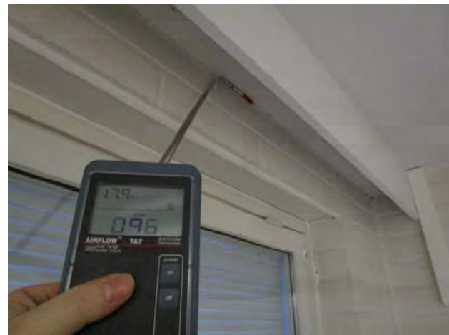
Kuvat 223-226: Vuotoilmavirtauksia yläpohjaverhouksen takaa kattoverhouksen ja ulkoseinän liitoksessa olevasta raosta (85)
