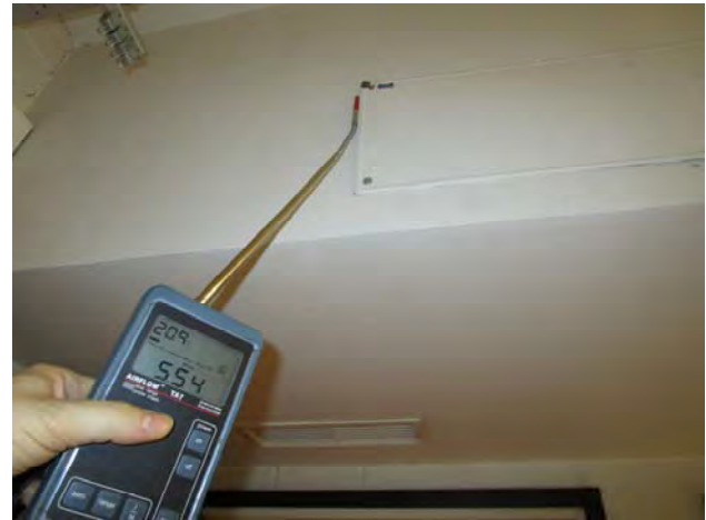
Kuvat 149 ja 150: Vuotoilmavirtauksia kotelorakenteesta luukun reunojen kautta (55)
