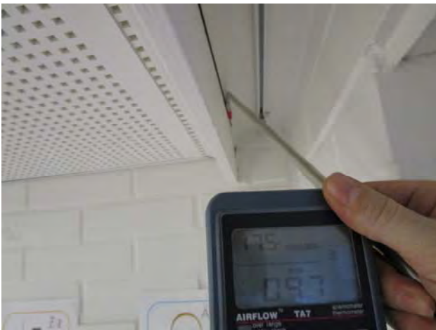
Kuvat 132-135: Vuotoilmavirtauksia ulkoseinän ja yläpohjan liitoksesta verholautarakenteen takaa (48)
