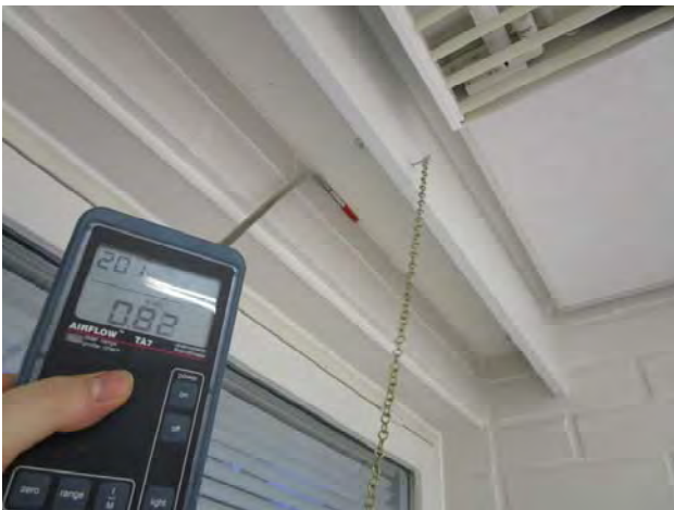
Kuvat 65-68: Vuotoilmavirtauksia ulkoseinän ja yläpohjan liitoksessa verholautarakenteen takaa (24)
