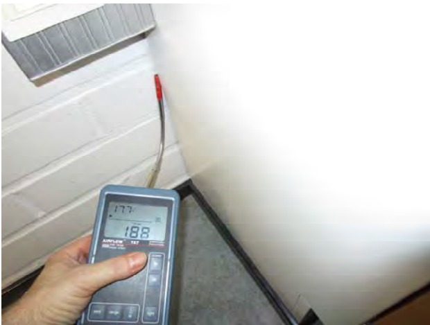
Kuvat 154-156: Vuotoilmavirtauksia ulkoseinän edessä olevan kaappirakenteen takaa (57)
