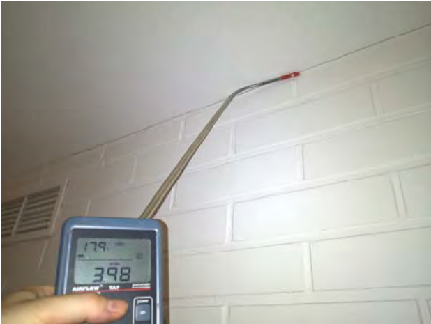
Kuvat 111-114: Vuotoilmavirtauksia alasasketun katon yläpuolelta kattoverhouksen ja väliseinien liitoksissa olevista halkeamista (43)
