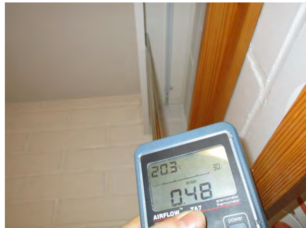
Kuvat 27-30: Vuotoilmavirtauksia ulkoseinän ja yläpohjan liitoksesta verholautarakenteen takana (12)
