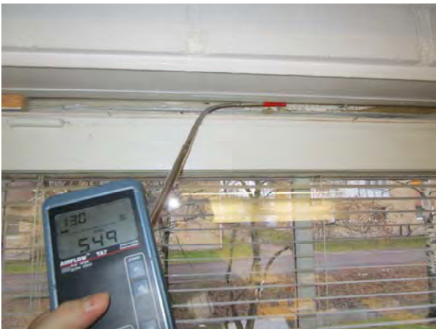
Kuvat 167-170: Vuotoilmavirtauksia ikkunan karmirakenteen ja ulkoseinän sisäkuoren välisestä raosta (62)
