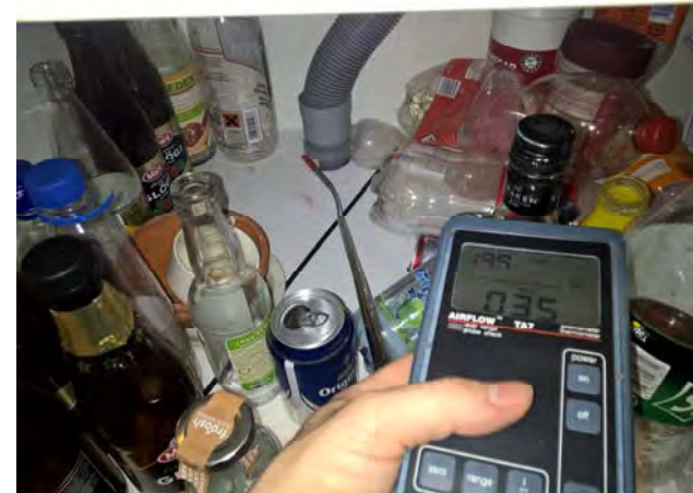
Kuvat 100 ja 101: Vuotoilmavirtauksia allaskaapin pohjalevyyn viemäriin tehdystä aukosta (39)
