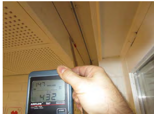
Kuvat 132-135: Vuotoilmavirtauksia ulkoseinän ja yläpohjan liitoksesta verholautarakenteen takaa (48)
