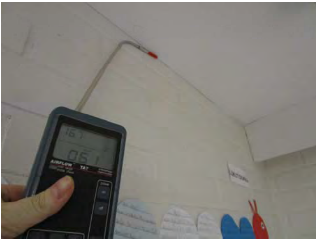
Kuvat 233-236: Vuotoilmavirtauksia väliseinän ja yläpohjaverhouksen liitoksesta (89)
