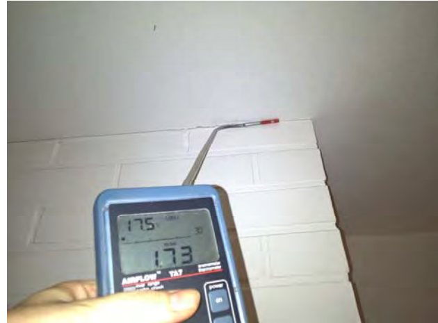
Kuvat 111-114: Vuotoilmavirtauksia alasasketun katon yläpuolelta kattoverhouksen ja väliseinien liitoksissa olevista halkeamista (43)
