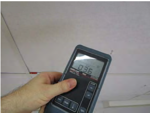
Kuvat 239-241: Vuotoilmavirtauksia alaslasketun kattoverhouksen yläpuolella (91)
