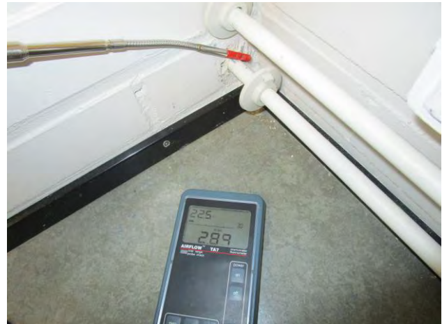
Kuvat 58 ja 59: Vuotoilmavirtauksia väliseinään lämpöputkille tehdyistä läpivienneistä (23)
