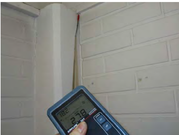
Kuvat 256-259: Vuotoilmavirtauksia tiiliseinien liitoksesta korkean tilan seinärakenteeseen (98)
