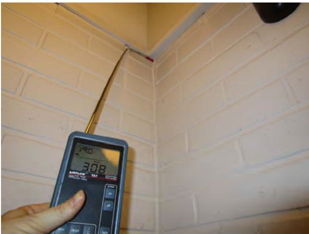
Kuvat 243-246: Vuotoilmavirtauksia tiiliseinän ja korkean tilan seinärakenteen liitoksesta (93)
