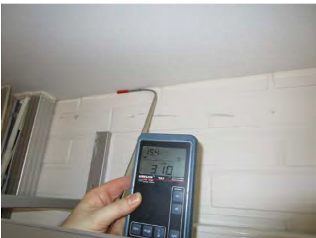
Kuvat 181-184: Vuotoilmavirtauksia väliseinän ja yläpohjaverhouksen välisestä raosta (68)
