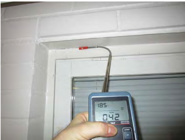
Kuvat 213-216: Vuotoilmavirtauksia ikkunan karmin ja seinärakenteen liitoksesta (81)
