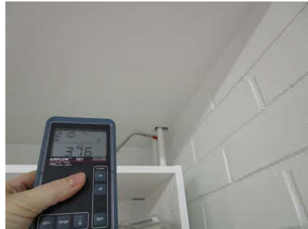
Kuvat 73 ja 74: Vuotoilmavirtauksia kotelarakenteesta putkille verhoukslevyyn tehdyistä läpivienneistä (27)
