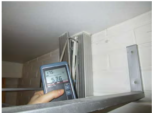
Kuvat 187 ja 188: Vuotoilmavirtauksia yläpohjaverhoukseen kaapeleille tehdystä ja puutteellisesti tiivistetystä läpiviennistä (70)
