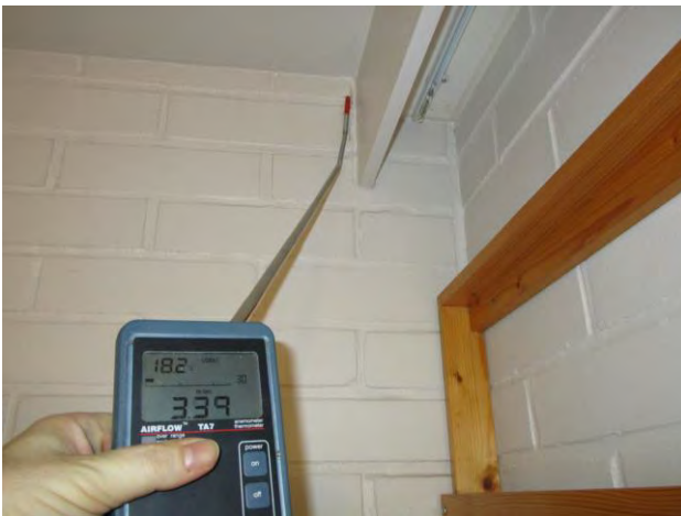
Kuvat 27-30: Vuotoilmavirtauksia ulkoseinän ja yläpohjan liitoksesta verholautarakenteen takana (12)
