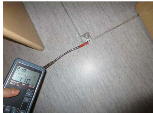
Kuvat 147 ja 148: Vuotoilmavirtauksia alapohjan lattialuukun reunasta (54)
