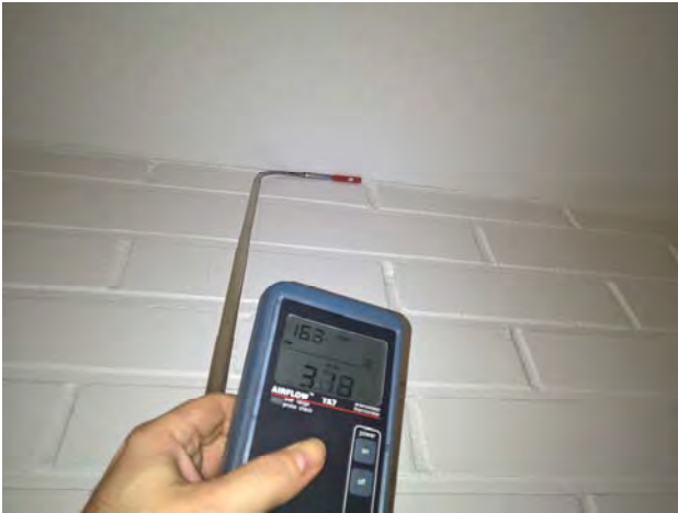
Kuvat 105-108: Vuotoilmavirtauksia kattoverhouksen ja väliseinän liitoksessa olevista halkeamista (41)
