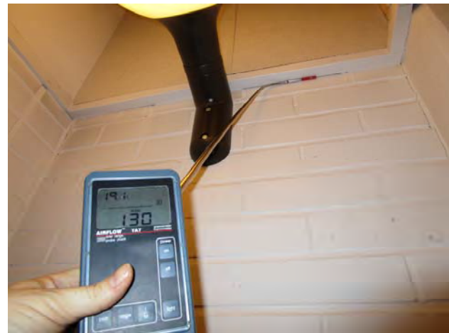
Kuvat 243-246: Vuotoilmavirtauksia tiiliseinän ja korkean tilan seinärakenteen liitoksesta (93)
