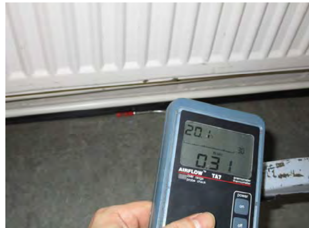
Kuvat 175 ja 176: Pieniä ilmanvuotovirtauksia ulkoseinän ja alapohjan liitoksesta (65)
