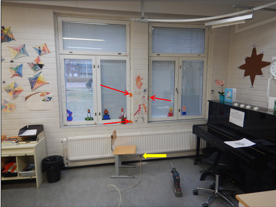
Kuva 66. Ilmavuoreittejä tilassa 184. Merkkiaineen syöttökohta on merkattu keltaisella nuolella.
