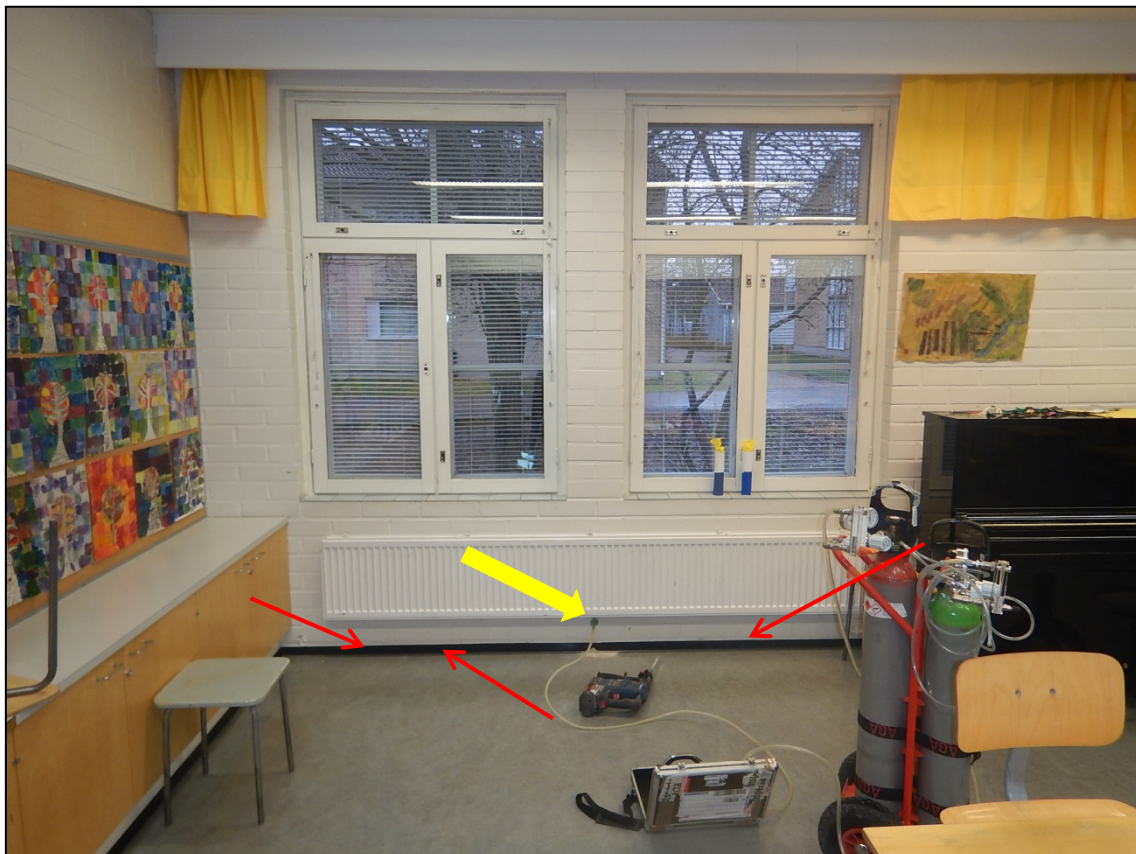
Kuva 65. Ilmavuotoreittejä tilassa 101. Merkkiaineen syöttökohta on merkattu keltaisella nuolella.
