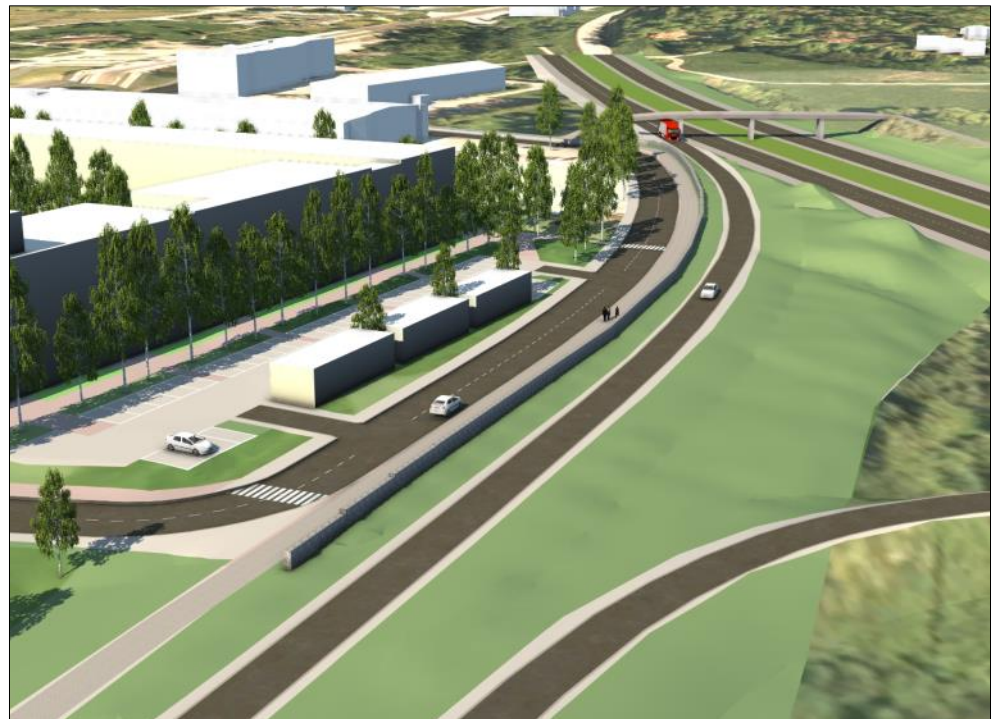
Kuva 22: Salmitien ja liittämärampin yhteensovittamisen tarkastelu (FCG 2017).
