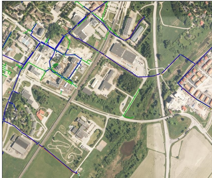
Kuva 10. Vesi- ja viemäriinjat suunnittelualueella sekä sen lähiympäristössä (siniset viivat vesijohtoverkosta ja vihreät viivat hulevesiverkosta).
