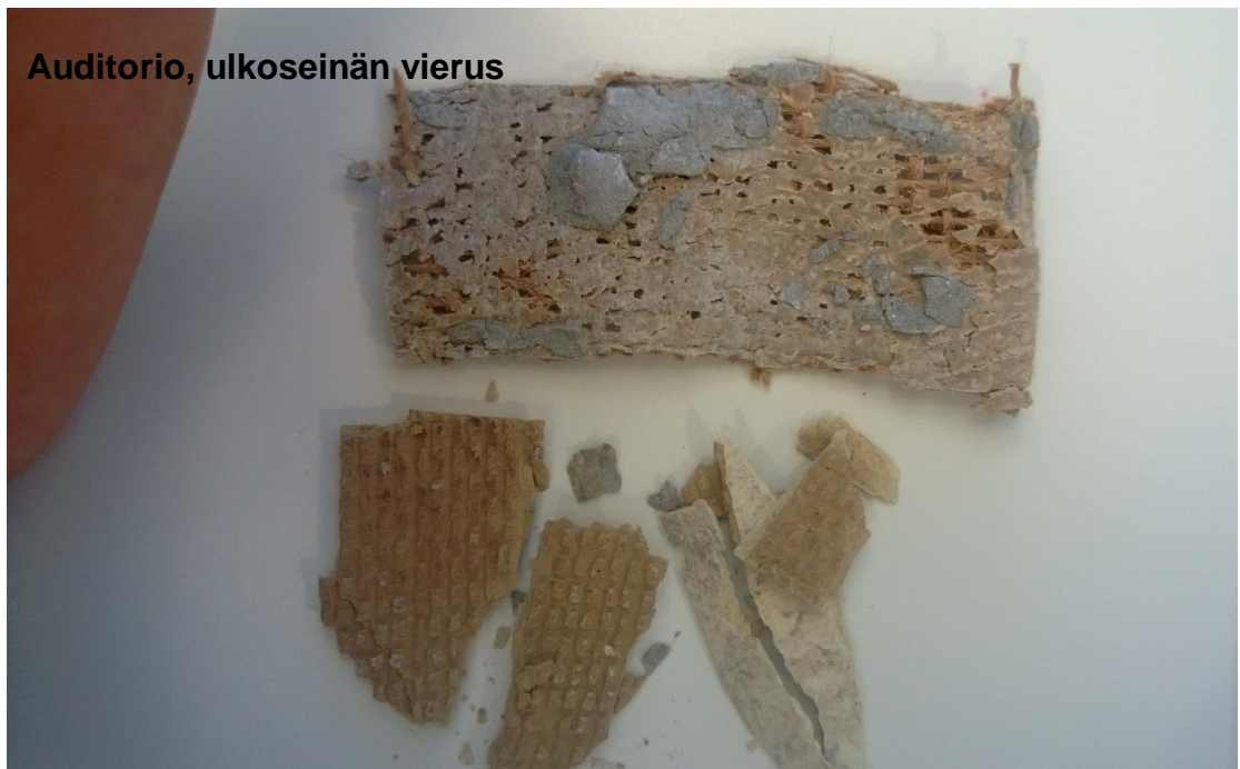
Kuvat 4-6. Kuvia linoleumimaton näytepaloista kirjastosta ja auditoriosta.
