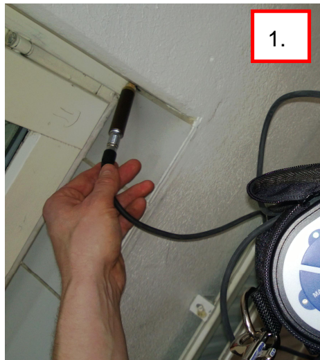
Kuvat 16–18. Huoneen 317 seinässä oli ilmanvuotokohtat ikkunan nurkassa ja lattia-seinä-liittymässä.
